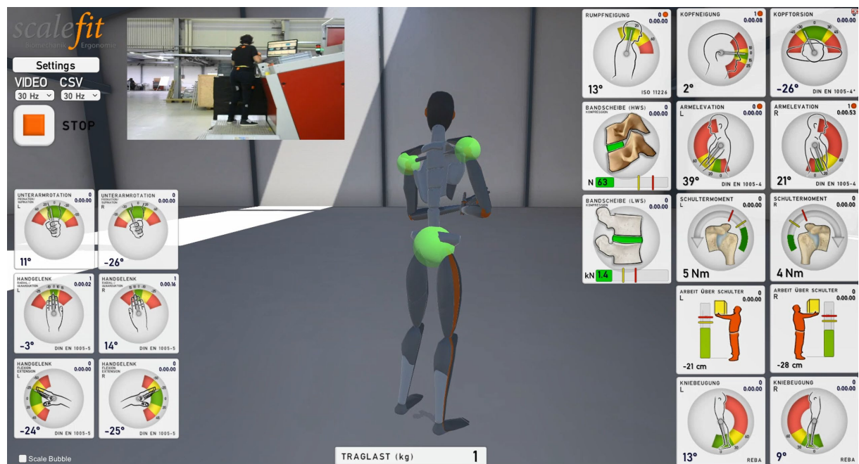
Abbildung 1: Darstellung der Motion Capture Visualisierung in Industrial Athlete mit synchroner Videodarstellung am Beispiel eines Ware-zur-Person-Kommissionier-Arbeitsplatzes.
